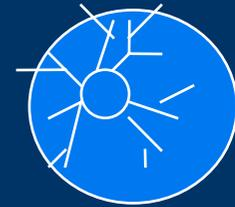
发生电晕后在导线周围积聚起空间电荷，好像增大了导线半径，导线的自波阻抗减小，耦合系数增大
