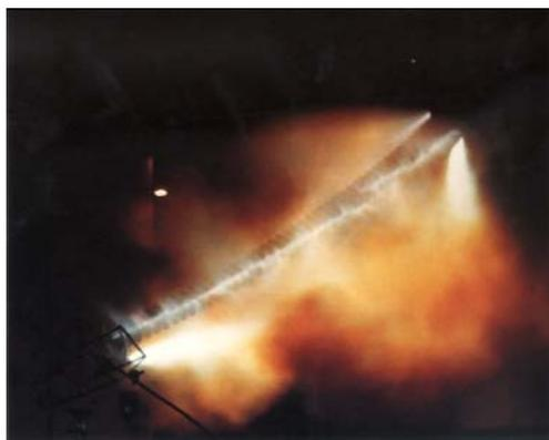
辽沈地区2001年2月22日遭遇最严重大面积停电事故，沈阳市区停电面积已经超过70%。辽沈停电事故是从高压输电线路污闪开始的。辽沈为我国重工业区，含盐的空气污染物附着在绝缘瓷瓶上，大雾湿气使瓷瓶绝缘能力降低，电弧沿着瓷瓶表面爬升，出现闪络放电现象。辽沈停电事故中，几乎所有的高压输电线路都出现污闪，停电事故最厉害的就是工业集中、污染严重的铁西区，该区全部停止了电力供应，损失巨大。
