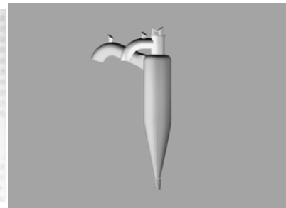
图 4-24 轴式细粉分离器结构示意图
