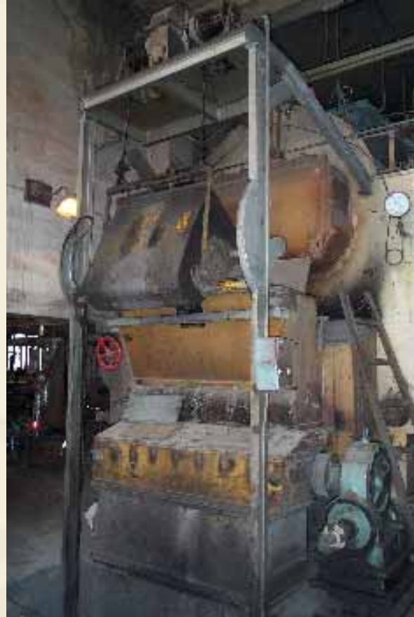
KZL4锅炉输送机(提升机)提升固体燃料
